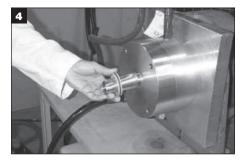
Alinhe a extremidade do cilindro formada com o cunho e a extremidade do eixo.
