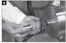
Use um cunho de latão com 0,005" de espessura cortado em um comprimento maior (aproximadamente 1/4") que a circunferência do eixo. Enrole o cunho e coloque no interior do selo.
