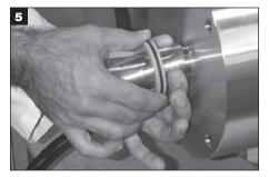
Deslize uma extremidade no eixo alargando o cilindro formado pelo cunho sobre a extremidade do eixo.
